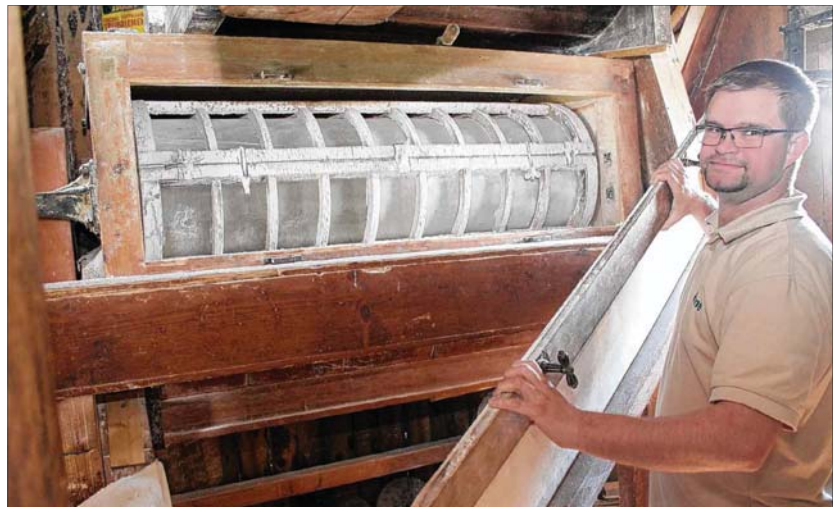
Rene Walkhoff an der Siebanlage der Bockwindmühle. Dort kommt das fertige Mehl an.
